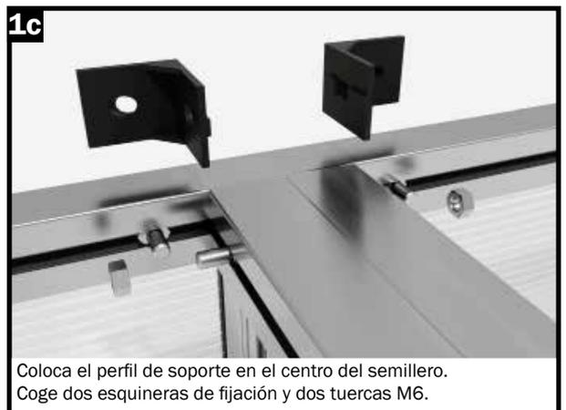
Coloca el perfil de soporte en el centro del semillero. Coge dos esquinas de fijación y dos tuercas M6.
