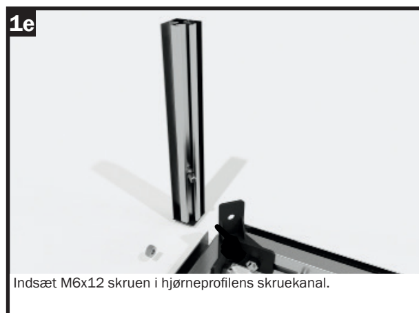
Når dækslet sidder godt fast, kan hjørneprofilen monteres.
