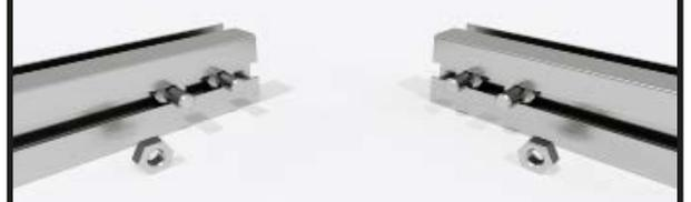
Insérez deux vis M6x12 mm dans le trou de passage des profilés.
