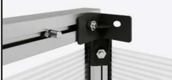
Alignez le profilé supérieur de manière à ce qu'il soit parfaitement aligné avec le coin du connecteur d'angle à l'arrière. Serrez fermement l'écrou M6.
