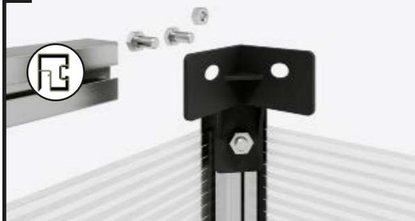
Prenez un profilé supérieur court, une vis M6x12 mm et un écrou M6.
