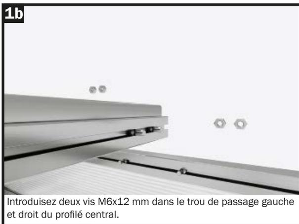
Introduisez deux vis M6x12 mm dans le trou de passage gauche et droit du profilé central.
